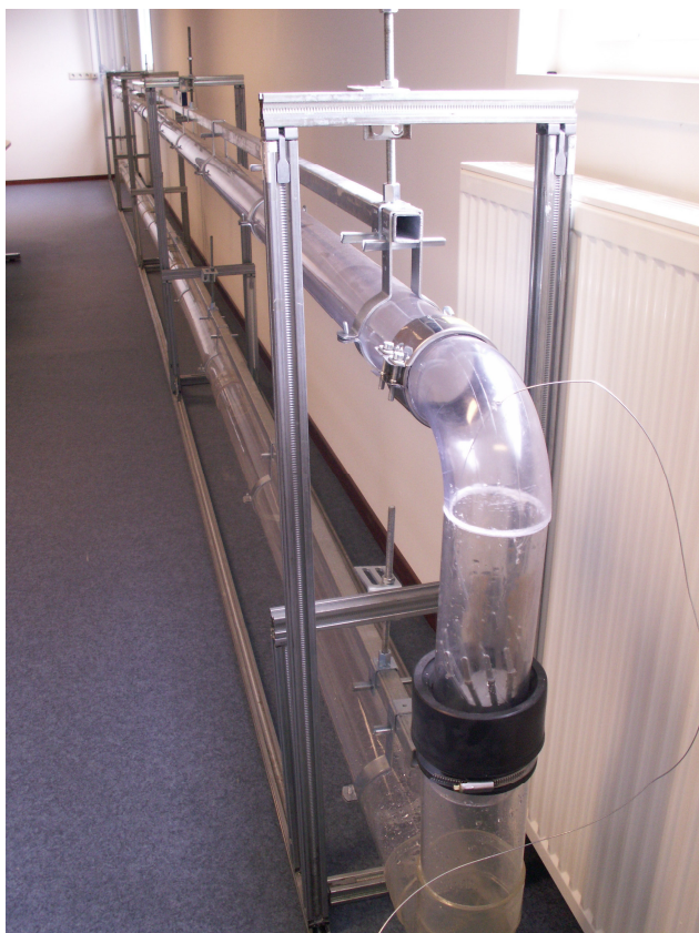
figuur 4-3 Meetopstelling van de grondleiding / huisaansluitleiding
